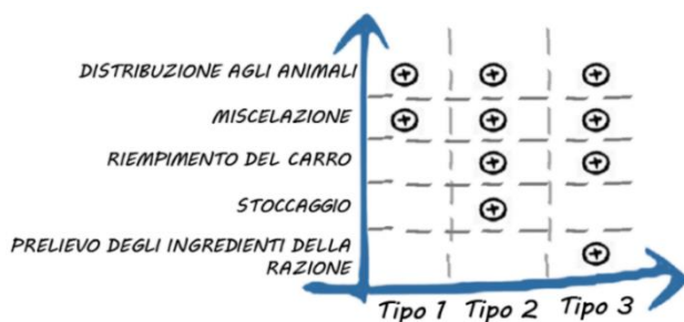
Figura 8. Le possibili tipologie di AFS e gli ambiti di automazione raggiungibili (Fonte: Rossi et al., 2021) 37
