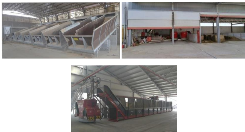
Figura 7. Esempi di edifici dedicati a cucina. In alto, a sinistra: cucina con container e scarico per gravità. In alto, a destra: cucina con gru automatica di carico. In basso, al centro: cucina con container e nastro trasportatore (Immagini dell'autore)
