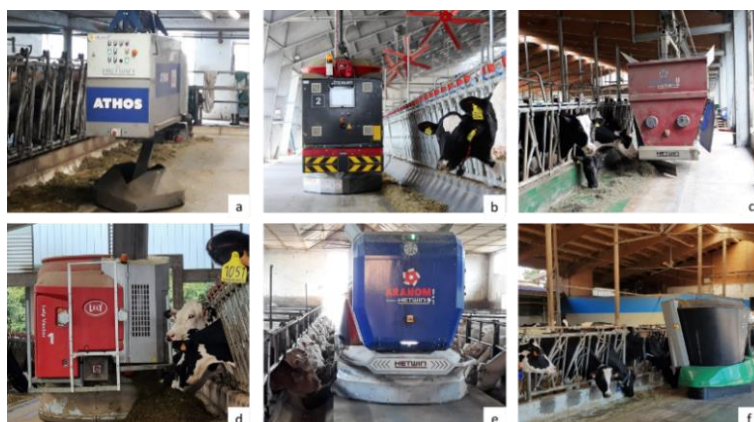
Figura 11. Differenti tipologie costruttive del sistema di distribuzione: a) sospeso solo distributore; b) guidato miscelatore-distributore; c) sospeso miscelatore-distributore; d,e,f) semovente miscelatore-distributore (Fonte: immagini dell'autore)
