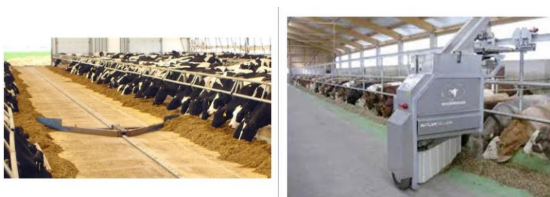
Figura 5. Esempi di sistemi spingiforaggio guidati. A sinistra sistema con ala inclinata; a destra sistema a tappeto mobile (Fonte: Dairymaster.com, Wasserbauer.at)
