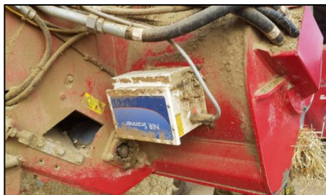
Figura 1. Sensore NIR installato sulla fresa del carro miscelatore (Immagine dell'autore)
