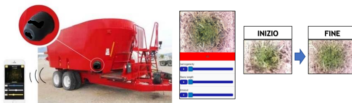
Figura 3. Installazione del sensore sul carro e connessione attraverso smartphone (a sinistra). Software di gestione del sensore e immagini acquisite all'inizio e alla fine della miscelazione (a destra).
