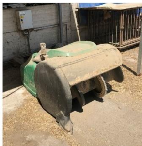
Figura 6. Esempi di sistemi spingiforaggio semoventi. A sinistra sistema a tamburo rotante; a destra sistema a coclea (Fonte: Immagine dell'autore)
