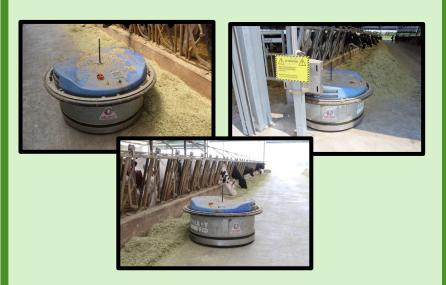
Robot spingi-foraggio automatico semovente con riavvicinamento rotante che effettua in questa azienda 12-14 operazioni nell'arco delle 24 ore
