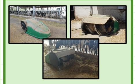
Robot spingi-foraggio automatico semovente con riavvicinamento a coclea a spinta laterale che percorre l'azienda grazie a sensori inseriti nella pavimentazione con almeno 4-6 riavvicinamenti al giorno
