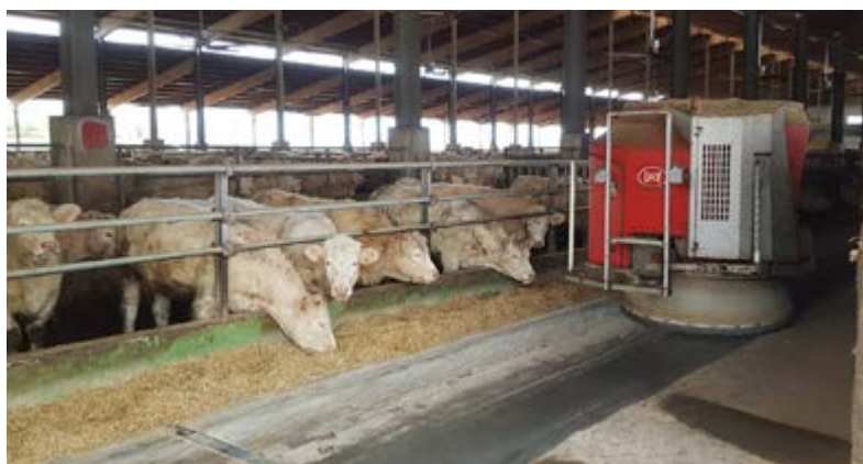
Due carrelli distributori della razione appartenenti alla tipologia semovente
