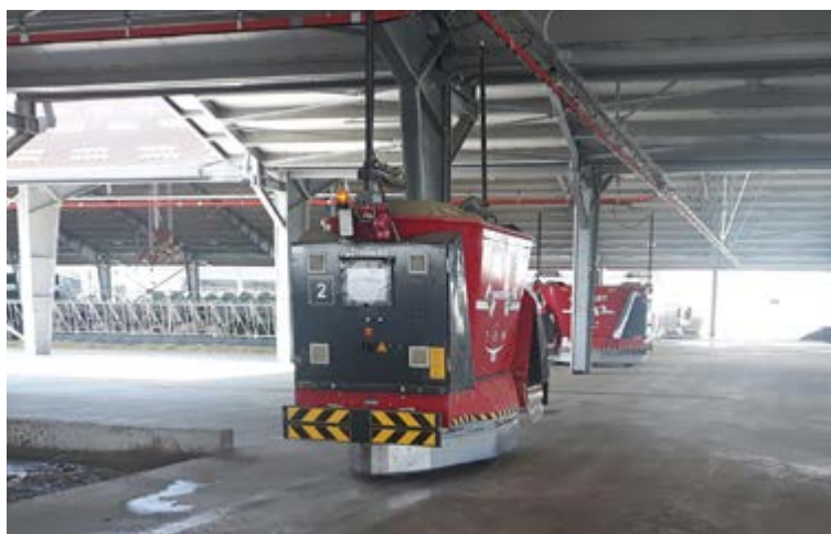
Due carrelli distributori della razione appartenenti alla tipologia carrello guidato
