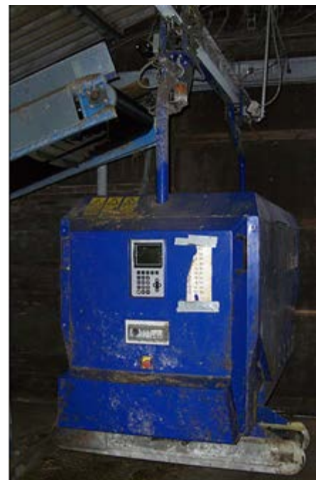
I carrelli distributori della razione possono essere sospesi, guidati e semoventi. In questa foto un esempio di carrello sospeso. Nelle prossime quattro foto esempi di carrelli guidati e semoventi
